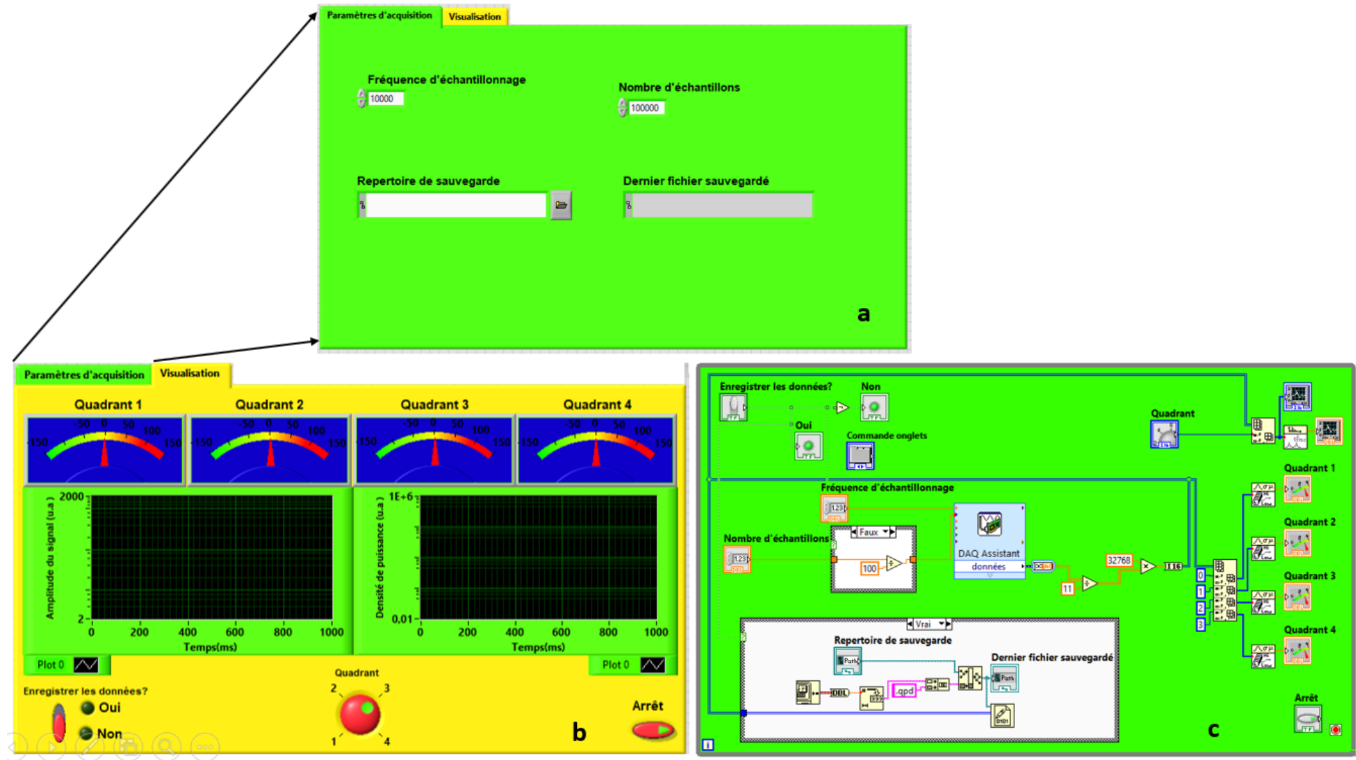
Figure 17 : (a, b) Interface utilisateur du programme de contrôle du QPD. (c) Diagramme de contrôle du QPD.
