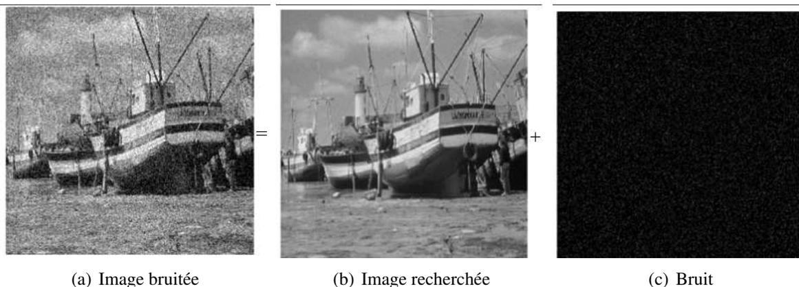
FIGURE I.19 – Représentation d’un signal 2-D bruité :  $Image\ bruitée = Image\ recherchée + Bruit$ .
