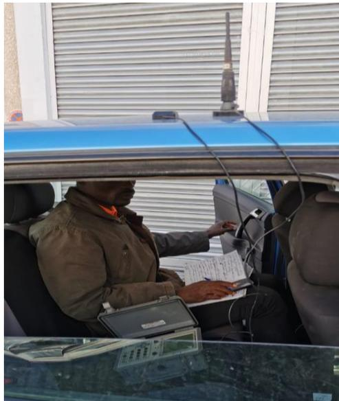
*Antenne réceptrice et GPS posés sur un véhicule*
