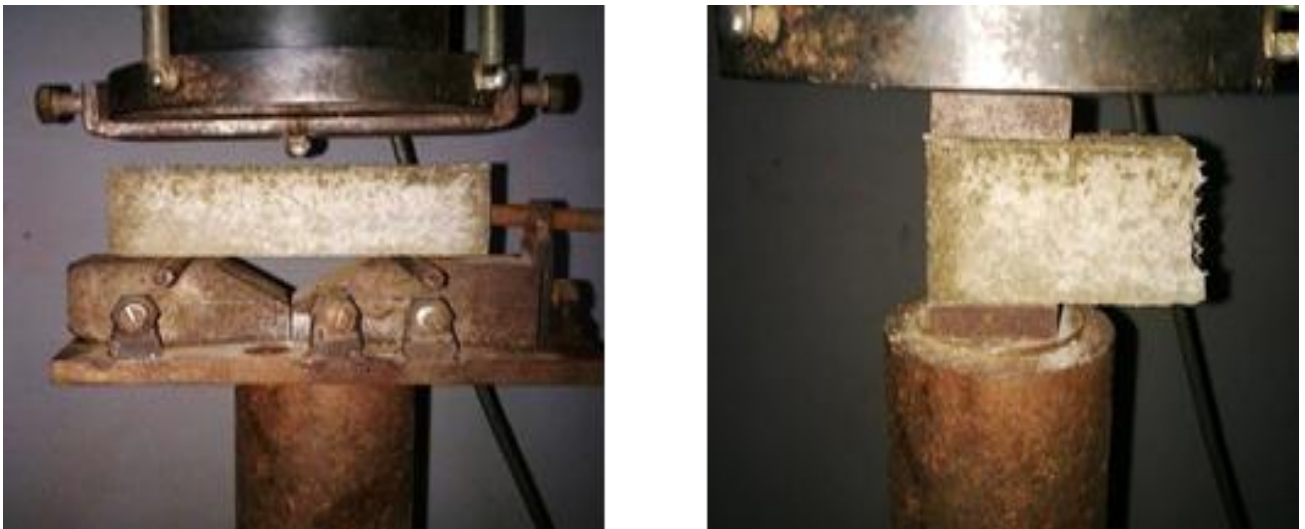
Photo 2-5 : Dispositif pour la réalisation des essais de flexion trois points et de compression
