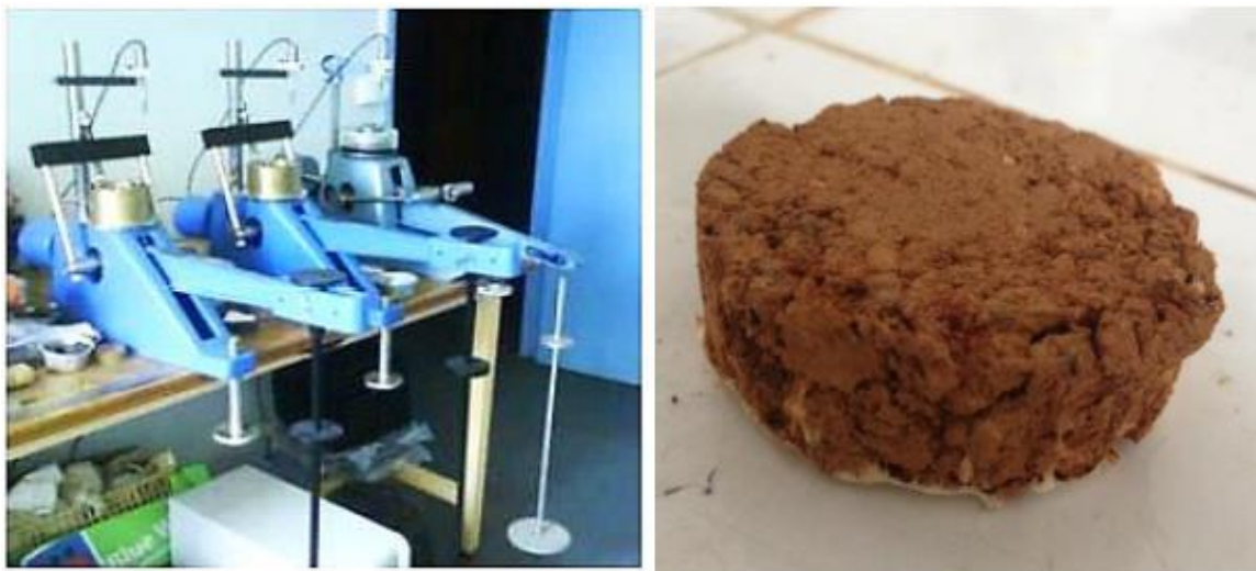
Figure 16 : Dispositif œdométrique permettant de réaliser l'essai œdométrique et éprouvette de sol après test de compressibilité.
