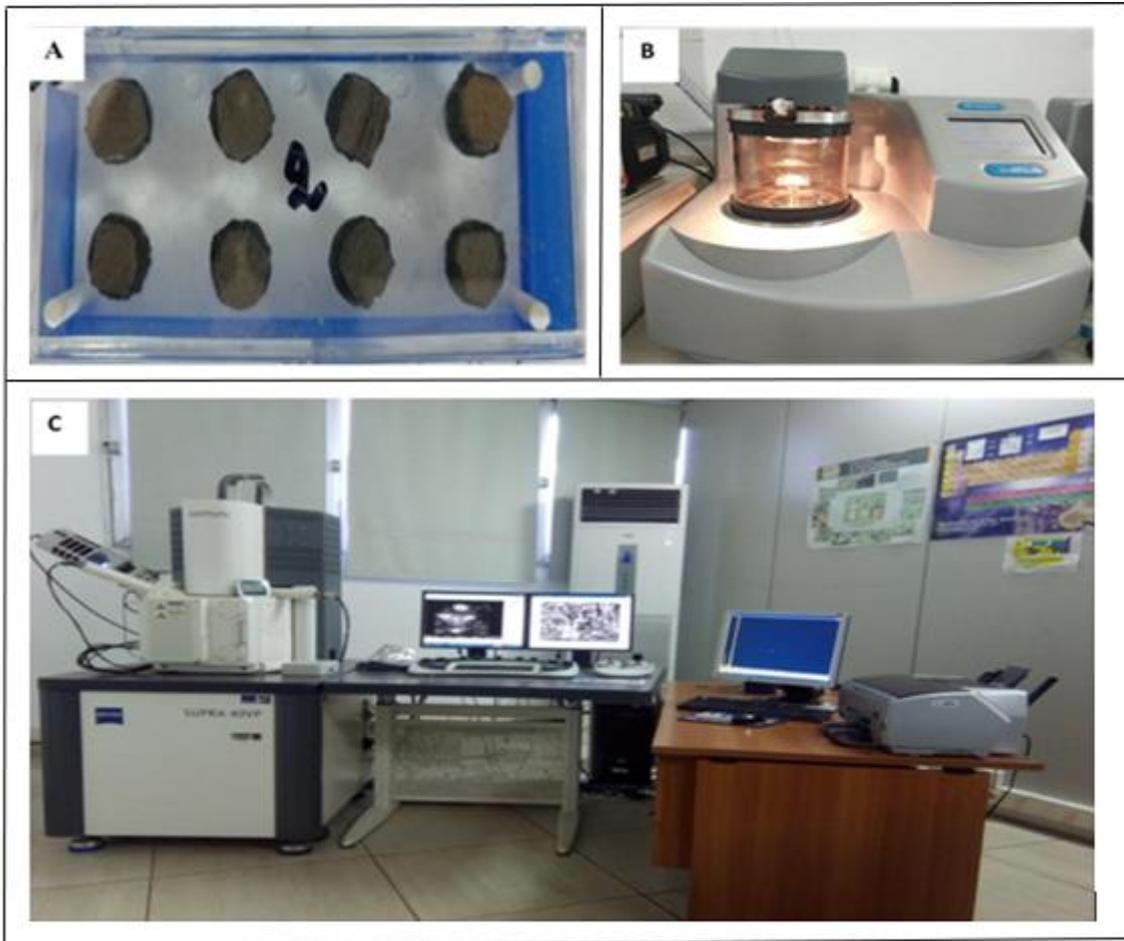
**Figure 20** : Matériel utilisé pour l'analyse de l'ultrastructure de grès. **A** : Echantillon de grès sur des porte-plots ; **B** : Métalliseur à or ; **C** : Microscope Electronique à Balayage (MEB FEG Supra 40 VP Zeiss) couplé à un Spectromètre à Dispersion d'Energie (EDS).
