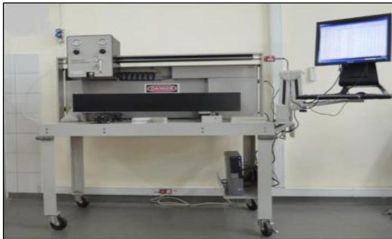
**Figure 16** : Perméamètre (PDPK-400<sup>TM</sup>) couplé à un ordinateur.
