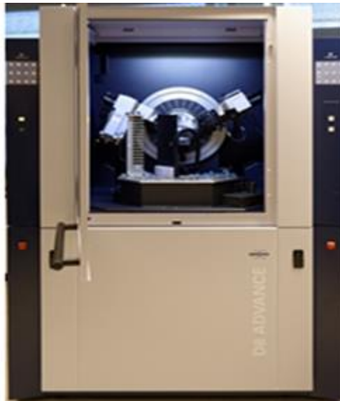
Figure 29 : Équipement d'analyse DRX (Diffractomètre Bruker type D8 ADVANCE).
