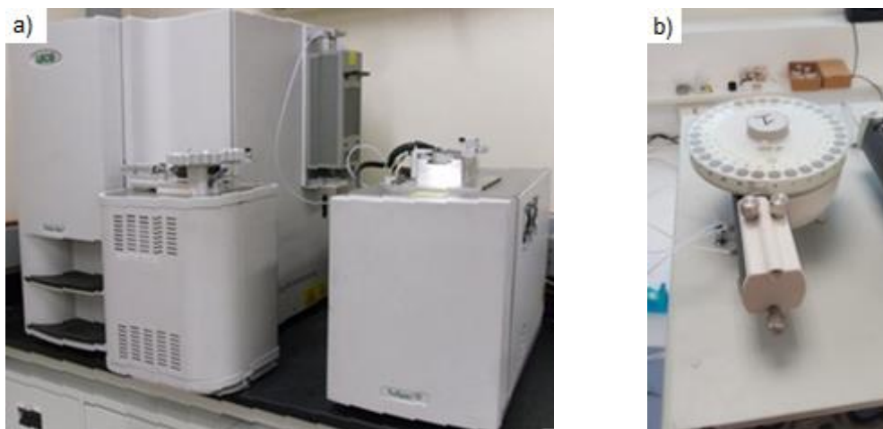
Figure 33 : Équipement d'analyse élémentaire : a) analyseur élémentaire CHNS-O (Leco TruSpec Micro) et b) son accessoire
