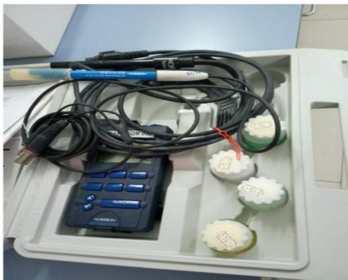
**Figure 14:** Sonde multi-paramètre portatif de type pH/cond 340i set b
