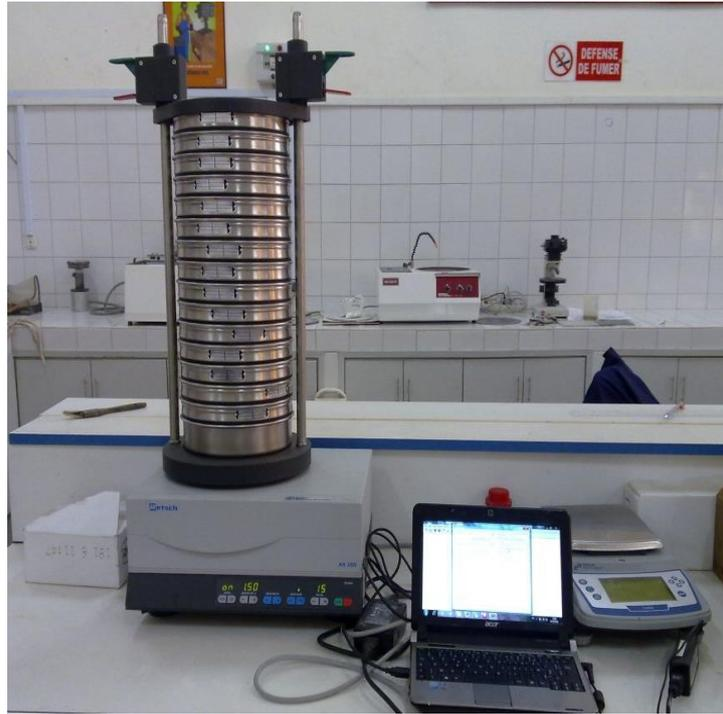
**Figure 19: Tamiseuse (AS 200 Control) vibrante à une colonne de quinze tamis (AFNOR)**
