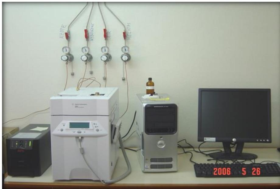
**Figure 27:** Chromatographe en phase gazeuse à détecteur d'ionisation de flamme (Agilent Technologies 6850)
