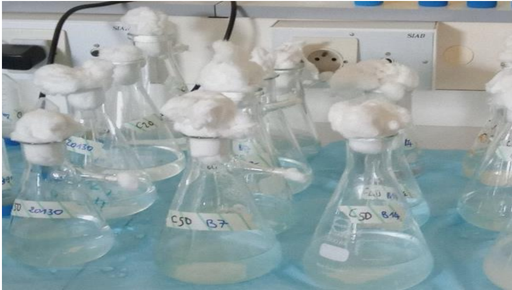
Figure 13: Test in vitro de dégradation de la cyperméthrine à 50 mg/L par Bacillus subtilis et Pseudomonas sp. (Psp 20130 ; Ba7 ; Ba14 ; Psp5)
