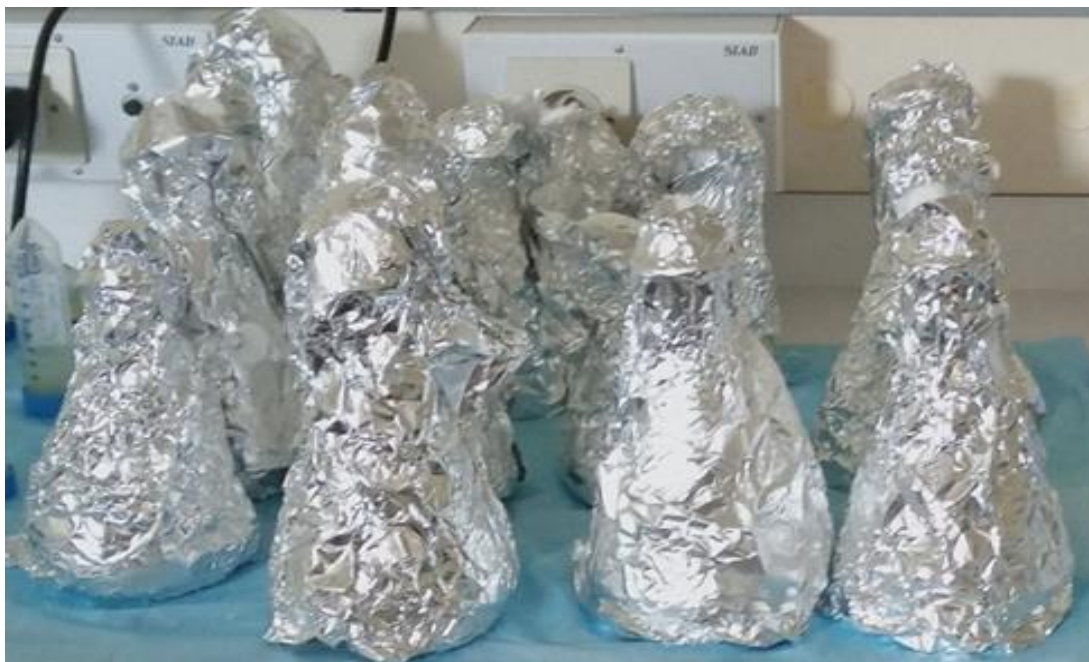
Figure 14: Test in vitro de dégradation du glyphosate par Bacillus subtilis et Pseudomonas sp. Afin de confirmer la biodégradation, les principaux composés biodégradés qui sont les principaux métabolites de la cyperméthrine et du glyphosate ont été analysés à partir du surnageant et confirmés par HPLC en début ( H_0 ) et à la fin de l'expérience ( H_{168} ) dans les mêmes conditions que celles décrites au chapitre II.2.5 .
