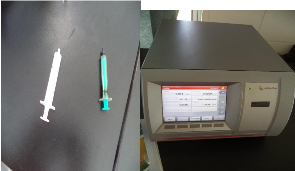
Figure 17 : Densimètre DMA 4100M avec deux seringues d'injection
