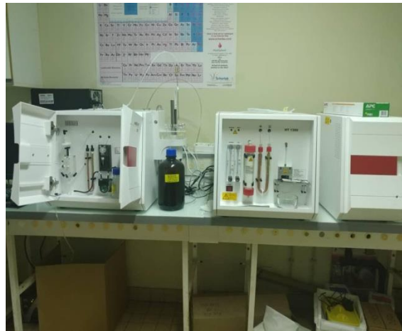
Figure 26 : COT-mètre Multi N/C
