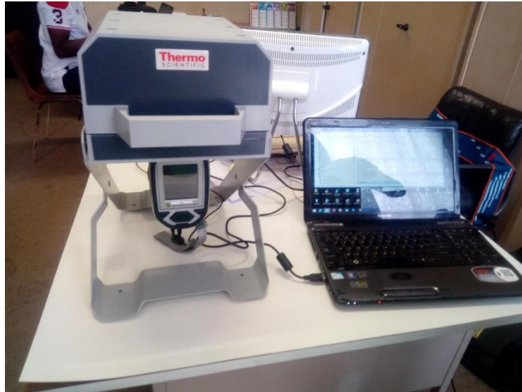
Figure 22 : Spectromètre à fluorescence de rayon X type Newton XL3T
