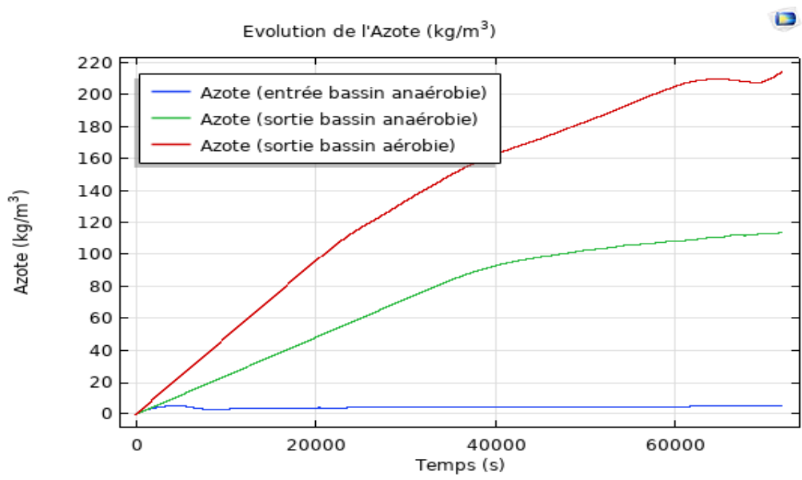
Figure 96 : Evolution du taux d'azote gazeux au cours du traitement pour v = 0,0005 m/s et un séjour de 20h.
