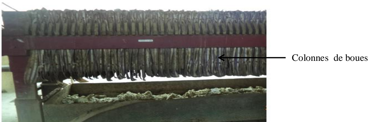
Figure 16 : Filtre à presse hydraulique des boues (Koné, 2016)
