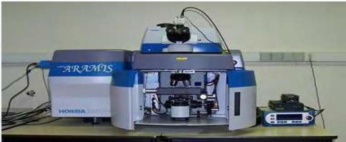
Figure 22: Photographie du spectromètre Raman
