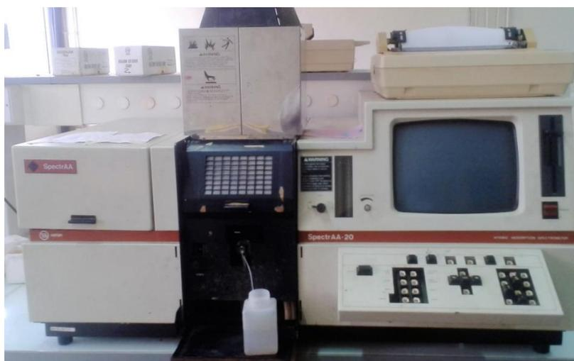
Figure 24: Photographie spectromètre d'adsorption atomique
