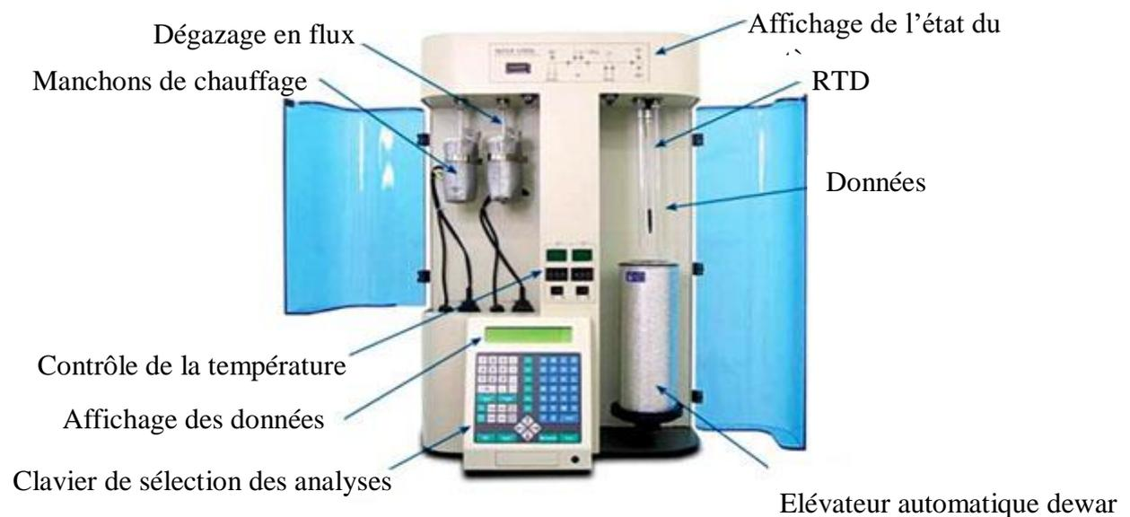
Figure 26: Photographie du spectromètre à l'analyse texturale
