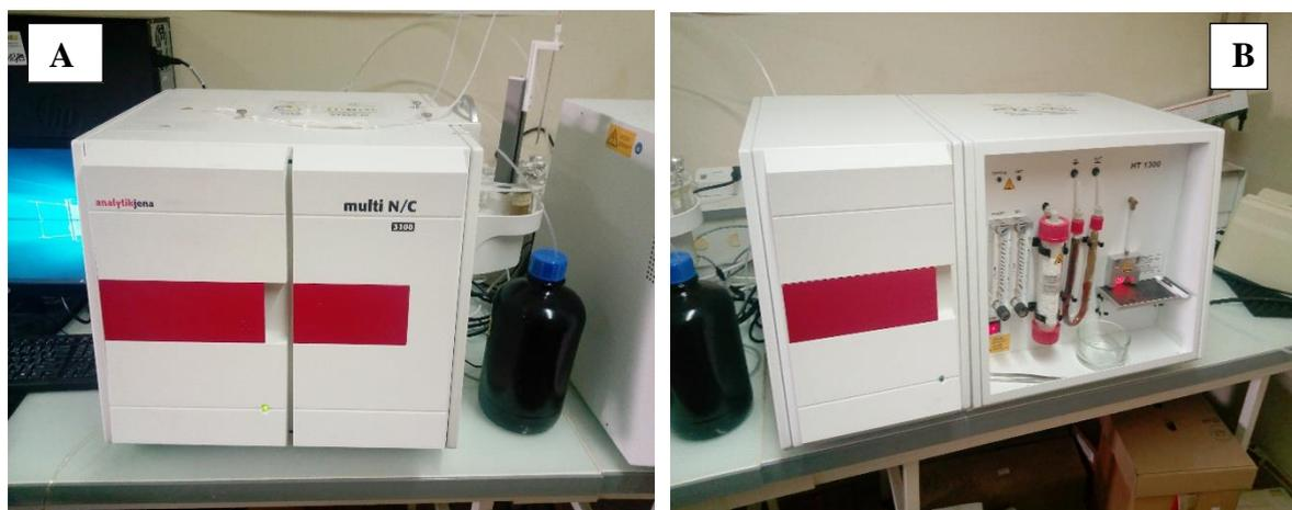
Figure 25: Photographie du COT-mètre à multi-fonction
