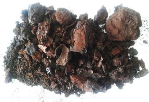
Figure 23: Poudre d'hydroxydes de fer préparés par réaction électrochimique
