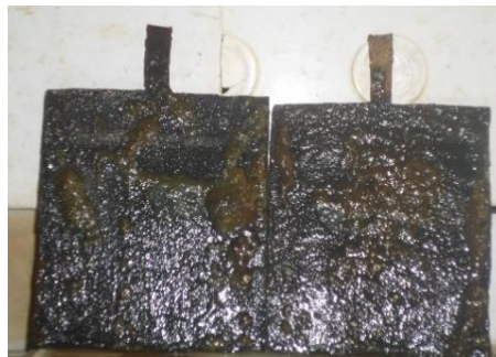
Figure 43: Encrassement des cathodes en fer après traitement par EC
