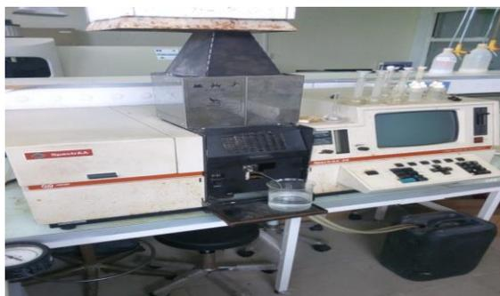
Figure II.14 : Spectroscopie d'absorption atomique dans la flamme pour le dosage des ions cadmium
