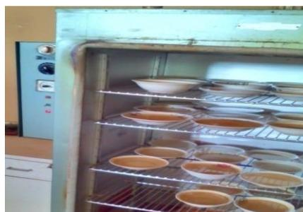
Figure II.3 : Séchage des argiles à l'étuve à 105°C
