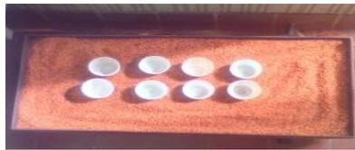
Figure II.19 : Bain de sable pour l'évaporation des mélanges contenus dans les capsules d'évaporation
