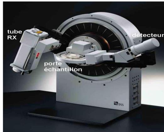
Figure II.10 : Dispositif de réalisation de diffraction de rayon X (DRX) (Bougeois, 2015)
