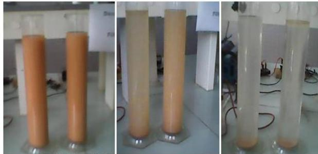
Figure II.4 : Etat du liquide dans l'éprouvette après 2 semaines de siphonage pour l'obtention de la fraction argileuse
