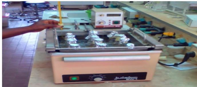
Figure II.12 : Dispositif utilisé pour les essais d'adsorption
