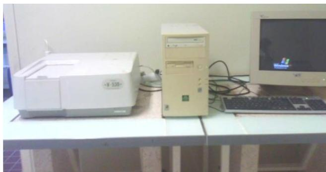
Figure II.13 : Spectrophotomètre UV-visible Jasco V-530 couplé à un logiciel intégré à un ordinateur
