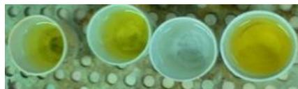
Figure II.20 : Présentation de la couleur jaune due à la formation du paranitrosalicylate de sodium dans les capsules d'évaporation
