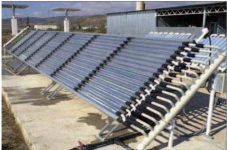
Figure 23: Réacteur pilote solaire installé sur la plateforme d'Almeria (Espagne) (Robert et al. , 2004)
