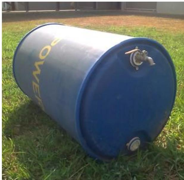
**Photographie 2 : Dispositif expérimental de digestion anaérobie en réacteur non agité**
