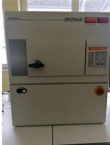
**Photographie 5 : Photographie du diffractomètre aux rayons X**
