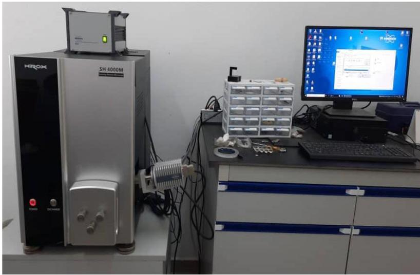
**Figure 16** : Photographie de l'appareil utilisé pour les analyses MEB/EDS des échantillons
