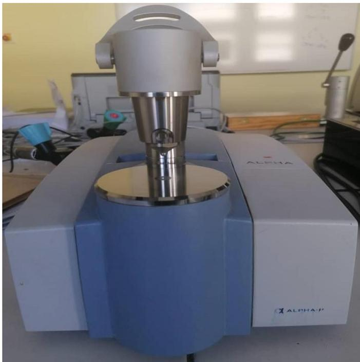
**Figure 15** : Spectrophotomètre IR Alpha-p
