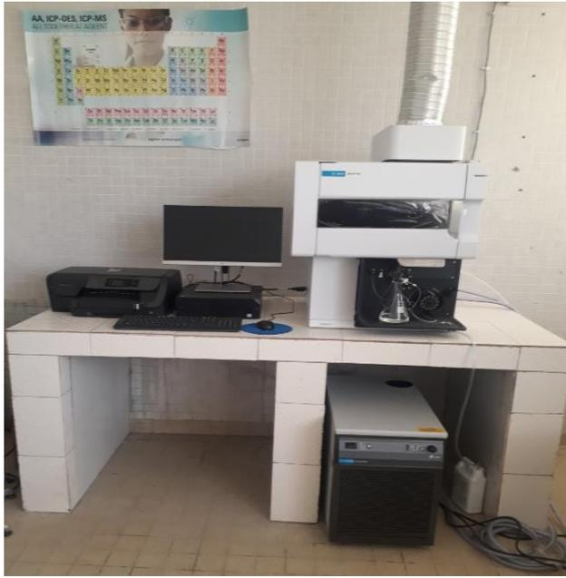
**Figure 13** : Spectromètre d'émission optique à plasma à couplage inductif
