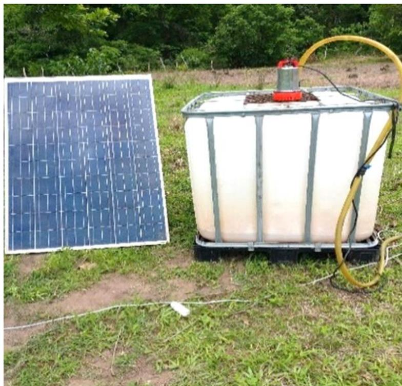
**Figure 24** : Panneau solaire et réservoir de 1000 litres
