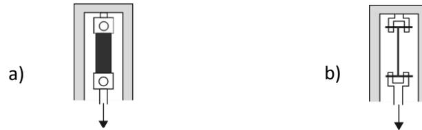
**Figure III.2.** : Portes-échantillons pour a) le film d'amidon plastifié et b) la fibre de coco
