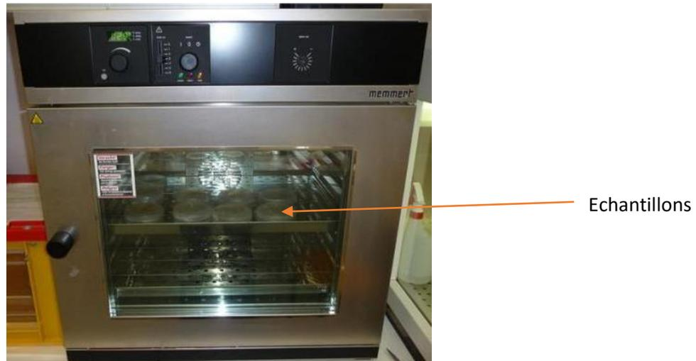
**Photo II-6 :** Présentation de l'étuve avec les moules contenant les échantillons
